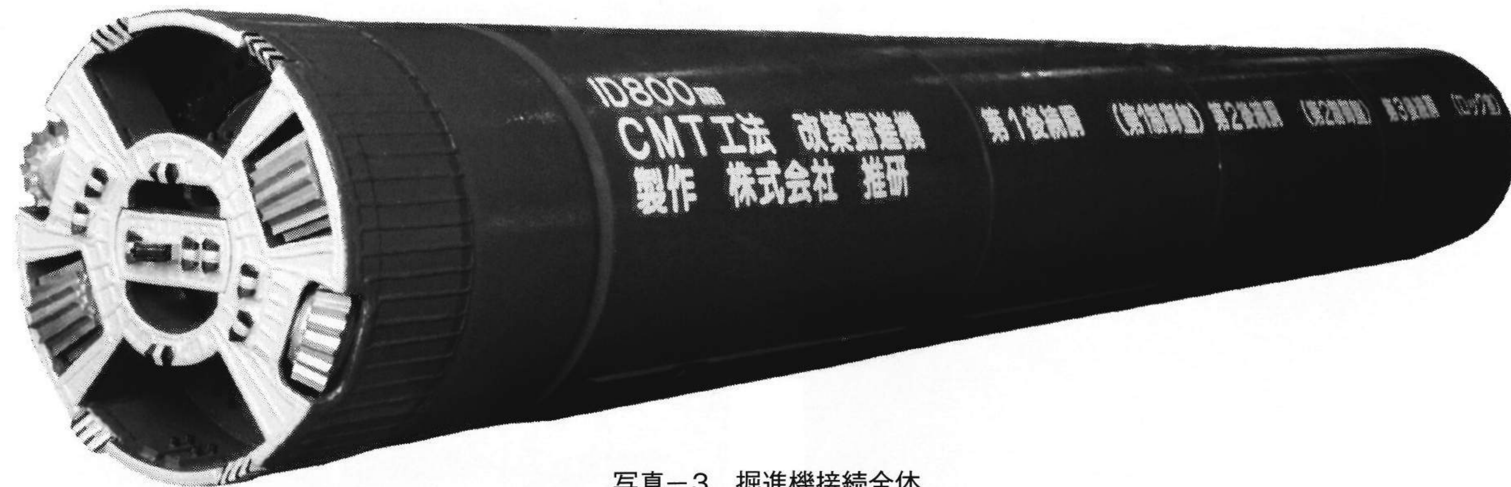
写真-3 掘進機接続全体
