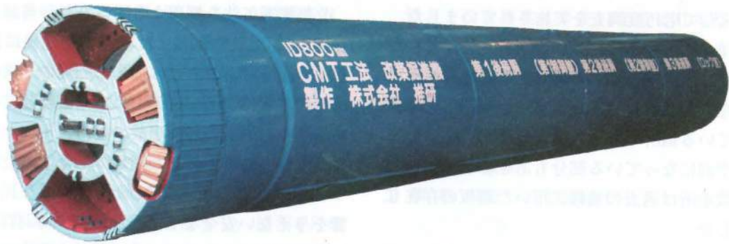
写真-3 掘進機全体
