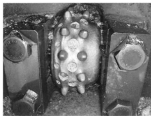
写真-12 ゲージカッタチップ破損
