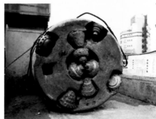
写真-2 異常磨耗した掘進機
