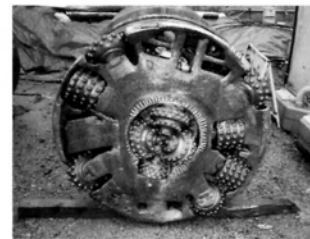
写真-3 異常磨耗した掘進機面板
