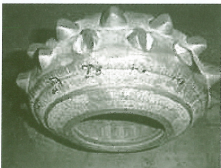
写真-7 チップ欠損部
